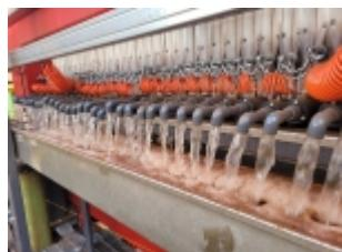
A Samarco iniciou, em julho, o comissionamento do filtro prensa, equipamento semi-industrial que irá possibilitar a construção de aterros experimentais com diversos cenários de mistura de rejeito arenoso e lama, para uma avaliação abrangente das melhores formas de disposição e do comportamento geotécnico das pilhas de rejeitos. A iniciativa é mais um avanço do Programa Estratégico de Soluções para Reserva, Rejeitos e Estéril.
