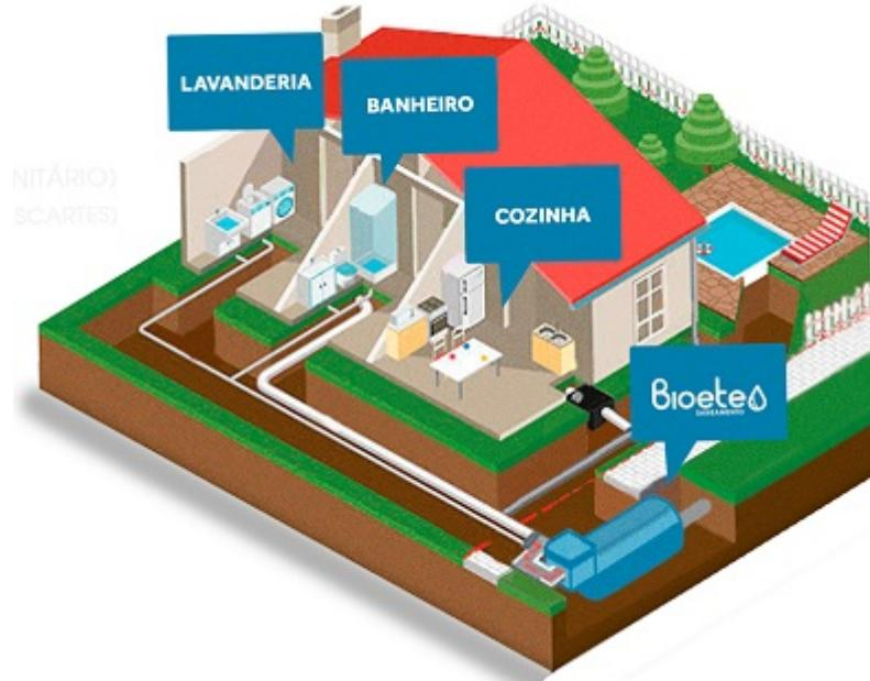
Ao todo são 5 estágios de tratamento, que ao final do processo de filtragem e purificação, geram na saída água padrão classe 2. O sistema trata o esgoto de forma completamente natural com eficiência de até 98% na remoção de impurezas.
